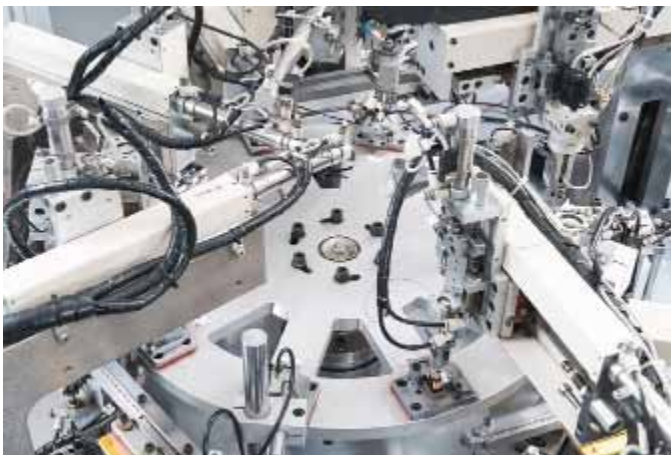
GQ-reläet är tillverkat i en helautomatisk produktionslina med automatisk kalibrering där algoritmerna utvecklats av Goodskys ingenjörer. Bara de reläer som faller utanför specifikationen kräver ett manuellt ingripande.
