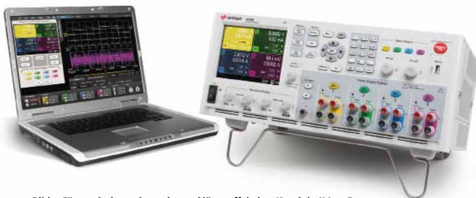
Bild 3. För emulering av batterier med lägre effekt kan Keysight N6705B DC Power Analyzer konfigureras med N6780-seriens SMU-effektmoduler. Dessa moduler kan emulera batterier med upp till 20V och upp till 8A.
