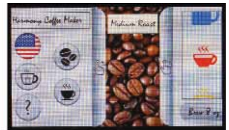
Figur 1. Till vänster syns en demo av nästan fotorealistisk bilddistorsion som kräver ett icke-flyktigt minne på runt 12 Mbyte. Till höger, en kaffebryggare, som inte har lika krävande grafik men ändå nyttjar cirka 3 Mbyte.
