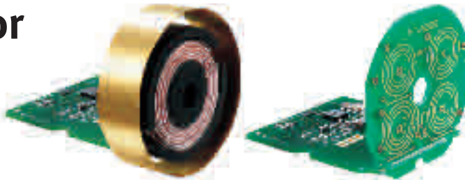
Den traditionella sensorn syns till vänster medan den nya sensorn som är tryckt på ett kretskort syns till höger.
